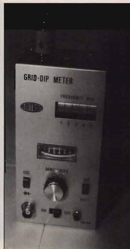
foto 1 Il Grid-Dip-Meter con tutte le prese e i comandi dei circuiti aggiuntivi.
