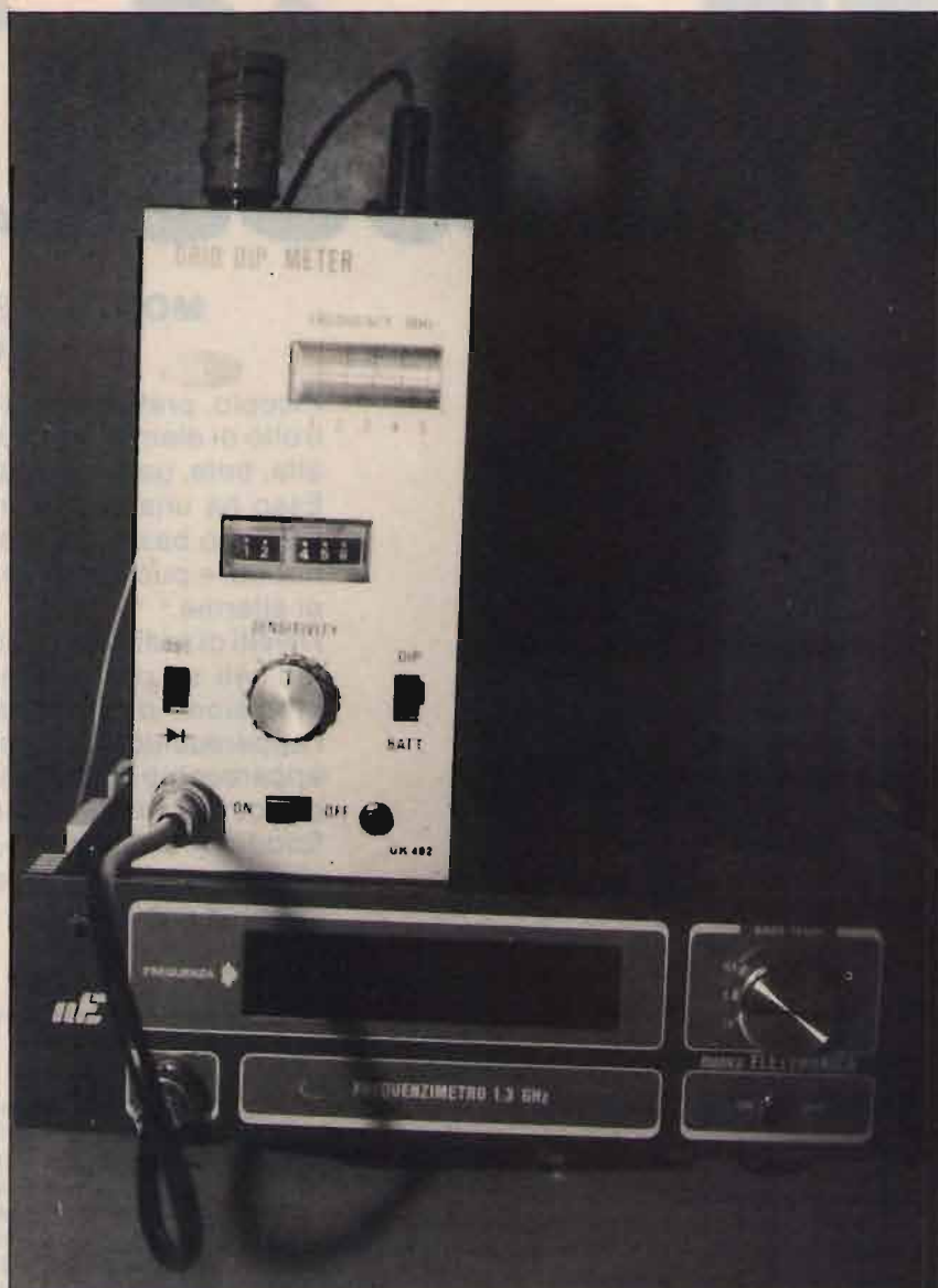
foto 2 L'emissione del GDM controllata con un frequenzimetro
